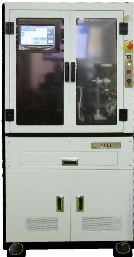
車載/産業機器を筆頭に、スマートフォン、ウェアラブルデバイス、医療機器などに搭載される**チップ部品は、高付加価値を求められ品質向上重視**となっています。ワーク各面を正対ダイレクトに撮像することで、精密な外観検査を行うとともにワークダメージレス対応を図り、**あくまでも本来の趣旨である「安定検査」にこだわり開発コンセプトといたしました。**4面/6面検査の中でも、2照明/カラーカメラ/バックライト等々安定検査をさらにパワーアップするオプション群も充実させております。
